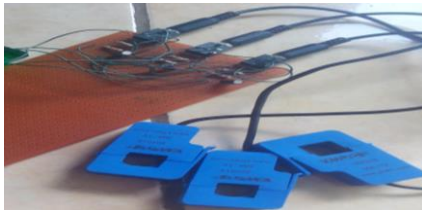
Gambar 25: Pengujian Dengan Kondisi Sensor Arus Tidak Dikaitkan Pada Kabel
