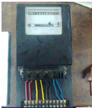
Gambar 8: Equipment Secara Fisik kWh Meter Tiga Fasa
