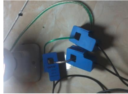
Gambar 33: Pengujian Dengan Kondisi Semua Sensor Arus Dikaitkan Pada Kabel
